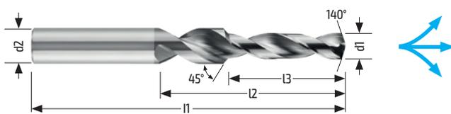
Con fori di lubrificazione / With internal coolant
