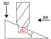
Diametro effettivo per frese semisferiche con angolo di penetrazione β=0°
