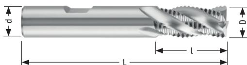
Con fori di lubrificazione / With internal coolant
