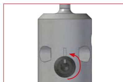
Otočte výstředníkový šroub o 180° zpět, aby zárez na výstředníku opět přiléhal k výřezu na základním tělese.
